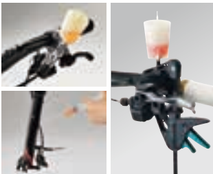
Otwarty zbiornik wyrównawczy
